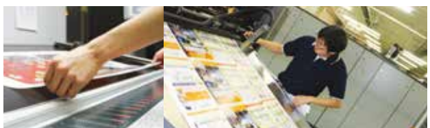
CCDカメラでスキャンされた情報を元に瞬時に欠陥をチェックします。
